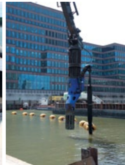
Рис. 4. DOP350 с дисковой фрезой и плавающим пульпопроводом
