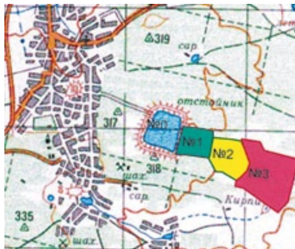
Рис. 1. Обзорная карта расположения площадок хвостохранилища: №№ 0 и 1 — законсервированы; № 2 — действующее; № 3 — проектируемое
