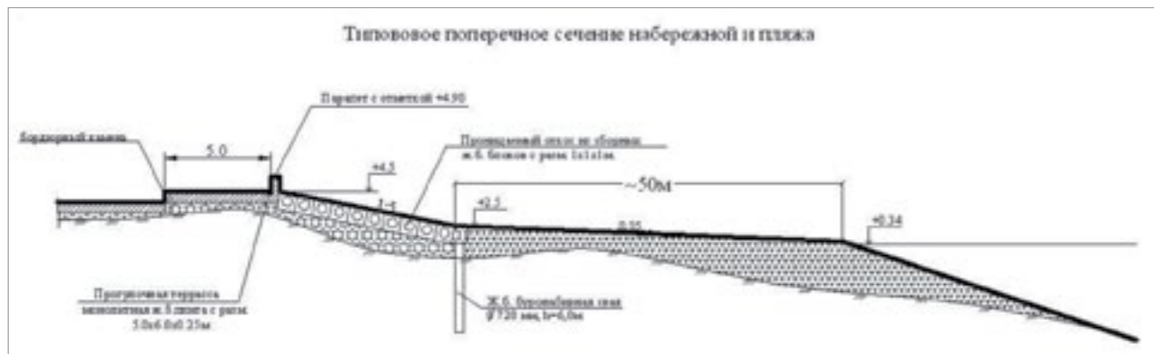
Рис. 7. Проектный разрез пляжа и набережной в Имеретинской низменности
