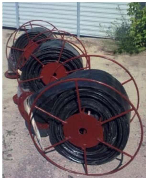
Рис. 8. Плоский грунтопровод, намотанный на барабан
