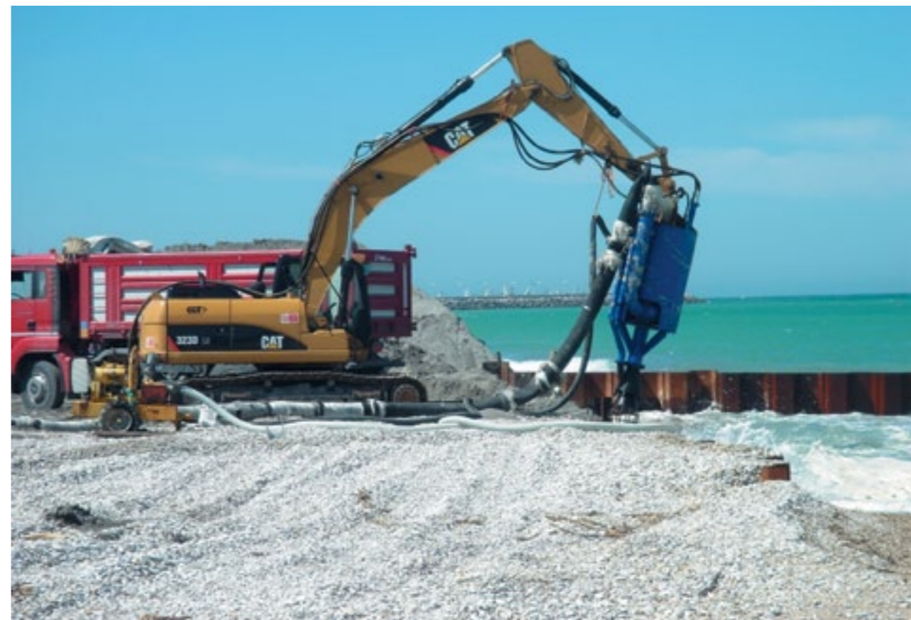
Рис. 4. DOP350 с дисковой фрезой и плавающим пульпопроводом
