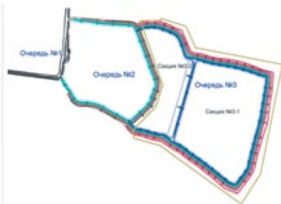
Рис. 4. План заполнения очереди №№ 2 и 3 хвостохранилища на окончание эксплуатации
