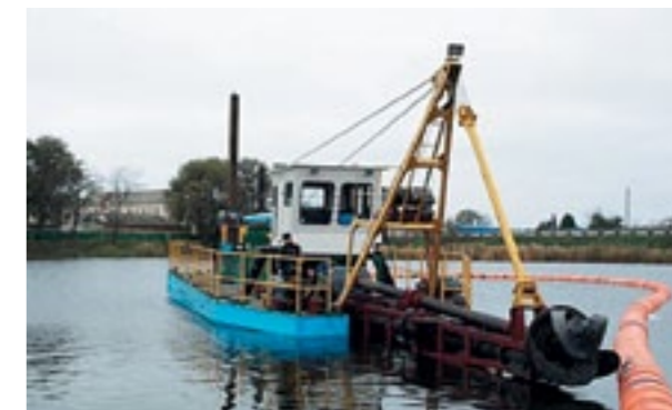
Рис. 6. Земснаряд, оснащенный гибким плавающим грунтопроводом диаметром 219 мм (производитель ООО «Рассвет-К»)
