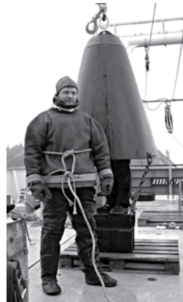
Рис. 3. Водолаз в кожаной «спецодежде» перед погружением в водолазный колокол (на заднем плане) (реконструкция снаряжения и оборудования конца XVII в., сделанная шведскими водолазами-историками в 1960-х гг.)
