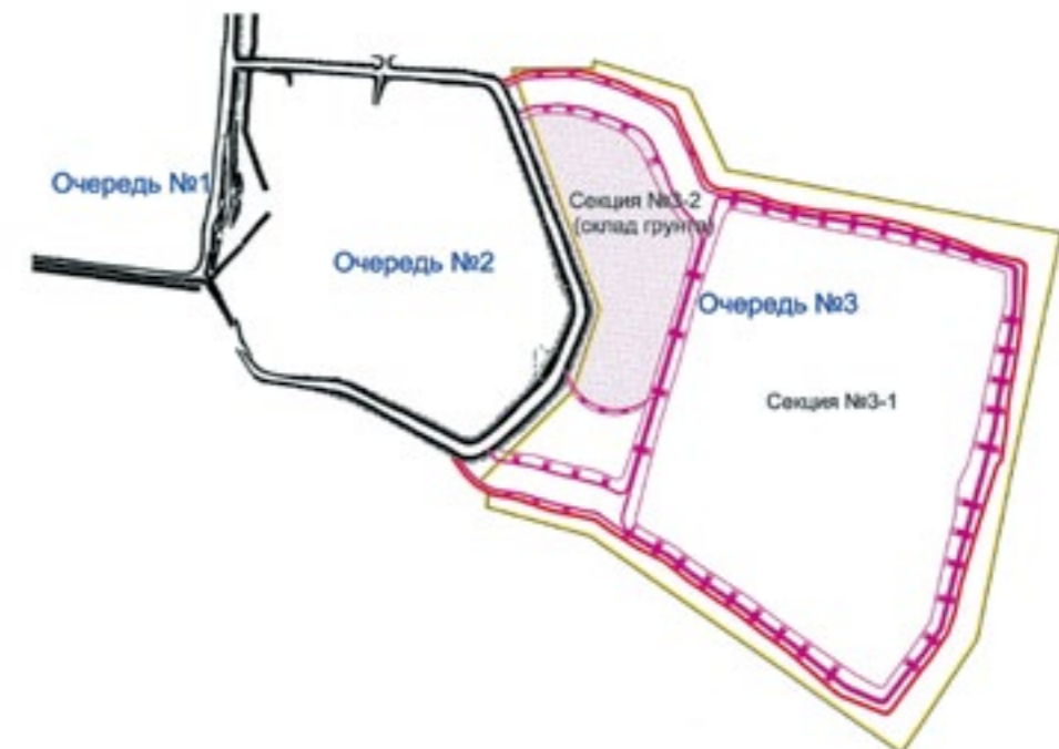
Рис. 3. Схема разделения чаши очереди № 3 на две секции
