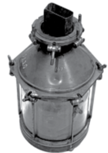
Рис. 8. Свечной фонарь барона Тизенгаузена на четыре свечи, предназначенный для работы в водолазных колоколах (образец 1853 г.)
