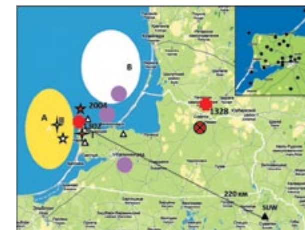
Рис. 2. Ситуационная схема сейсмической обстановки в Калининградской области: желтый (А) и белый (В) овалы — области наибольшей концентрации эпицентров землетрясений, по данным внешних систем наблюдений (Норвегии, Польши, Швеции); красные кресты — предполагаемые очаговые зоны исторических сильных землетрясений; 4-лепестковые звезды — предполагаемые макросейсмические эпицентры Калининградского землетрясения 2004 г. (I — Никонов и др., II — Ассиновская); звезды — инструментальные места расположения эпицентра Калининградского землетрясения 2004 г. (красная заливка — данные NORSAR, белая — Швеция); розовые кружки — места разработки нефтяных месторождений, где зарегистрированы очаги слабых землетрясений; белые треугольники — временная сеть сейсмических станций ИО РАН; красный круг с косым крестом — место расположения малоапертурного зряя в 2011 г.; черный треугольник — ближайшая к месту событий сейсмическая польская станция SUW. Врезка на схеме — распределение эпицентров слабых землетрясений, зарегистрированных временной сетью ИФС РАН в 2007–2008 гг.
