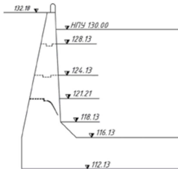
Рис. 2. Поперечное сечение поврежденных секций
