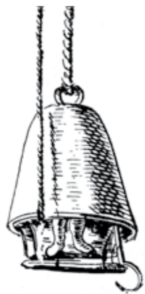
Рис. 1. Одноместный водолазный колокол конца XVII в. Так его изобразил очевидец водолажных работ аббат Негри в своей книге Viaggio Settentrionale , изданной в Падуе в 1700 г.
