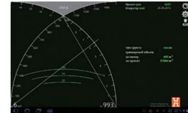
Рис. 3. Интерфейс системы Nonius Slurrymeter
