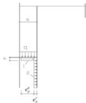
Рис. 5. Вид эпюры отпора перед экранирующей стенкой (1 — составляющая отпора за счет пригрузки отпорного грунтового массива, 2 — то же от полного собственного веса отпорного массива)
