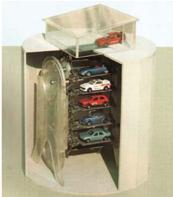
Рис. 1. Простейшая система подземных небольших паркингов типа Pater Noster Parking System
