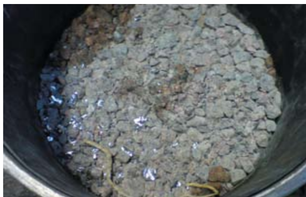
Рис. 1. Вид поверхности щебня фр. 5–20 мм после приложения к нему нагрузки в ходе испытания геомембраны на прокол
