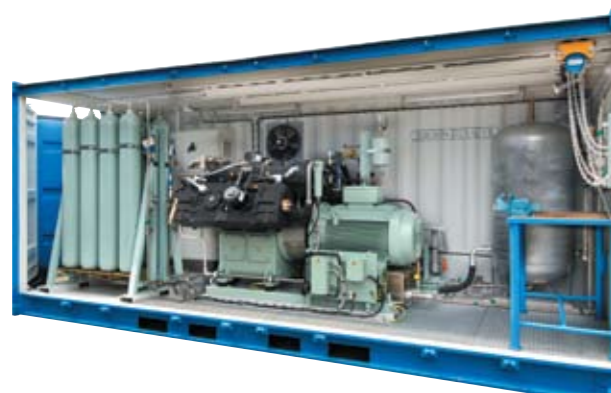
Рис. 1. МКС на базе воздушного компрессора J.P.SAUER&SOHN серии 6000
