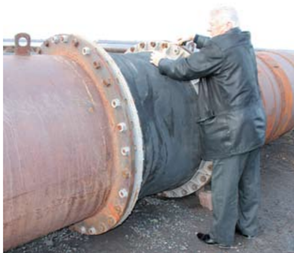
Рис. 3. Испытания эластичного компенсатора диаметром 1200 мм
