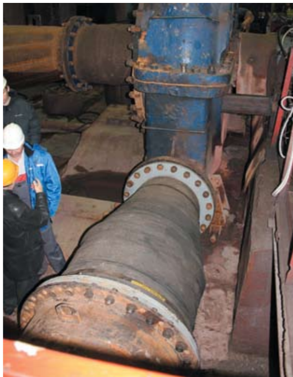
Рис. 2. Испытания опытного эластичного переходника диаметром 950 × 610 мм
