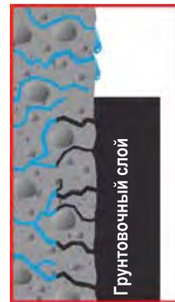
**Рис. 4.** Принцип работы грунтовочного слоя
