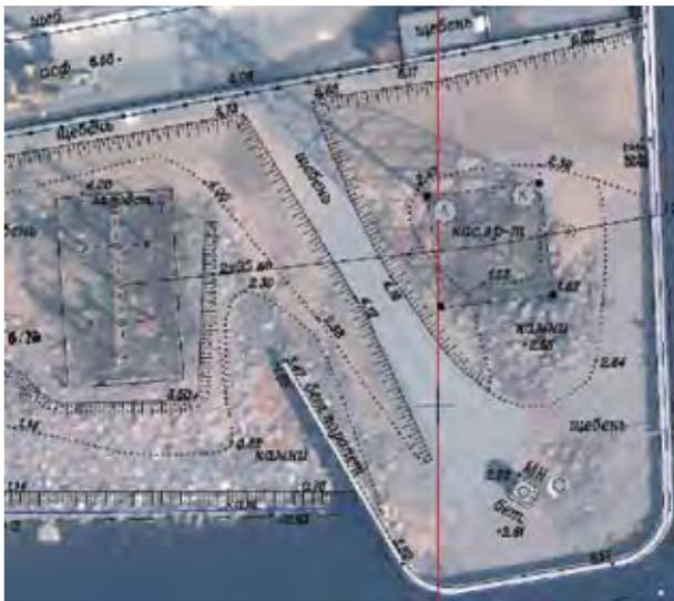
**Рис. 1. Фрагмент ортофотоплана с наложенным топографическим планом М 1:500**
