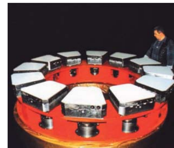
Рис. 3. Примерный общий вид опорного стола подпятника гидроагрегата с ЭМП-сегментами
