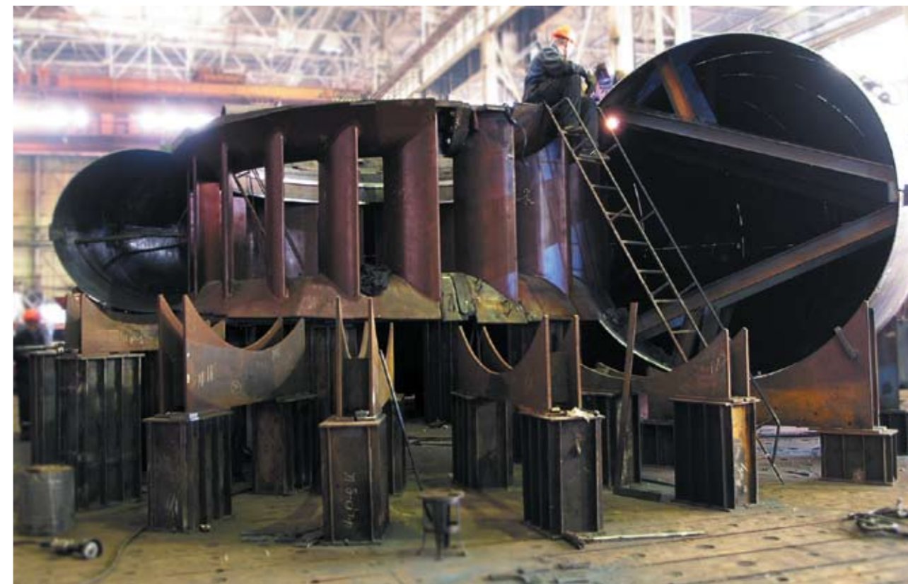
Фото 1. Сборка пропеллерной гидротурбины для Гельбахской ГЭС (Дагестан). ПР40-В-300. Мощность N = 22,6 МВт, Д.р.к. = 3,0 м. 2005–2006 гг.
