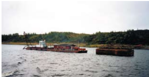
Рис. 10. Оптимальным решением синхронного перемещения обеспечивающей плавплощадки (слева) явилось применение «подрезного понтона» (справа). 2002 г. р. Енисей
