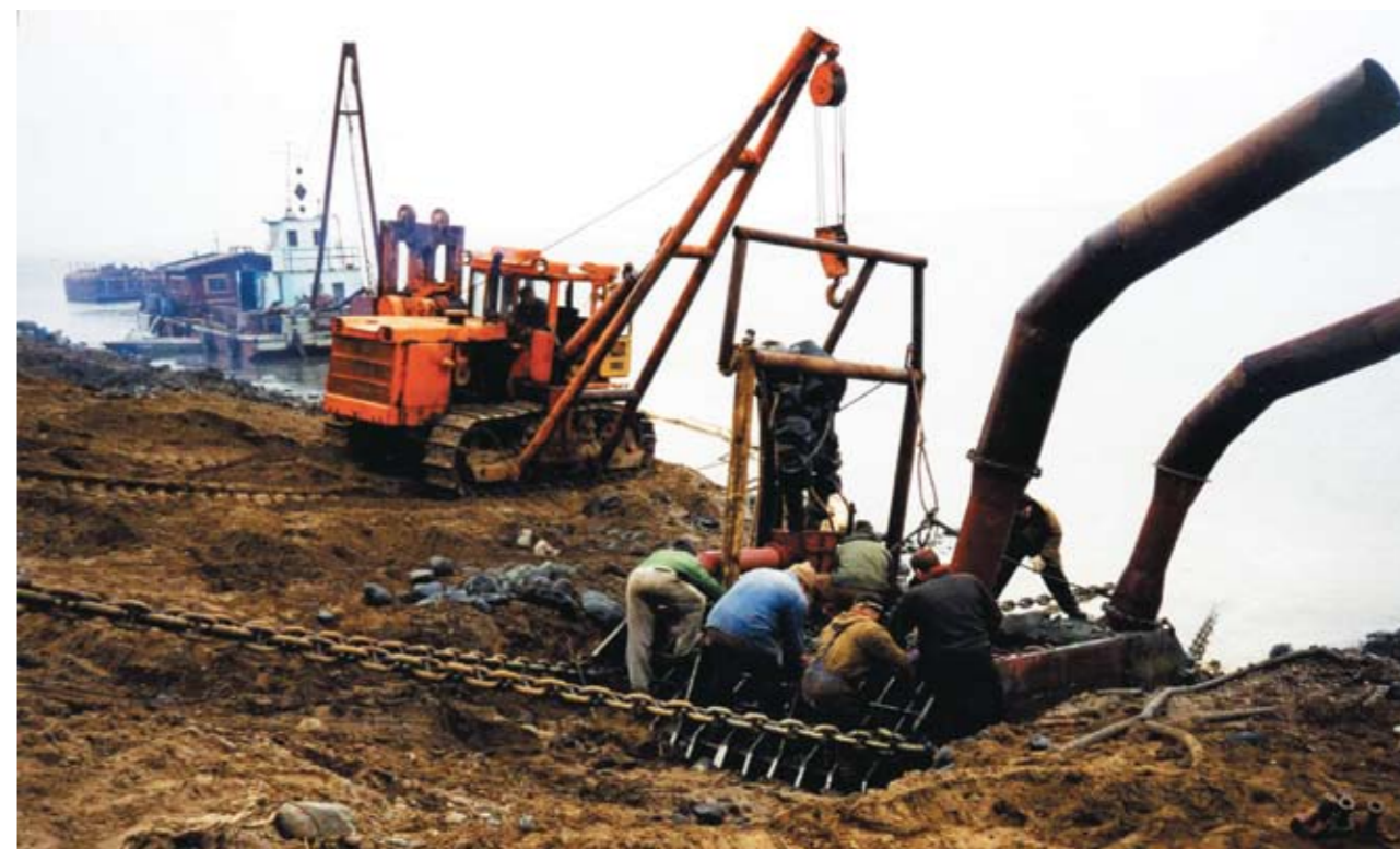
Рис. 11. «Гидронож» последнего поколения. Рабочие удаляют камни из кузовной емкости. 2002 г. р. Енисей
