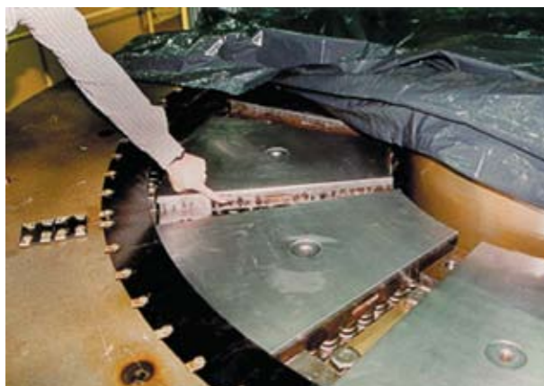
Рис. 4. Пружинный подпятник с баббитовыми сегментами с принудительной смазкой
