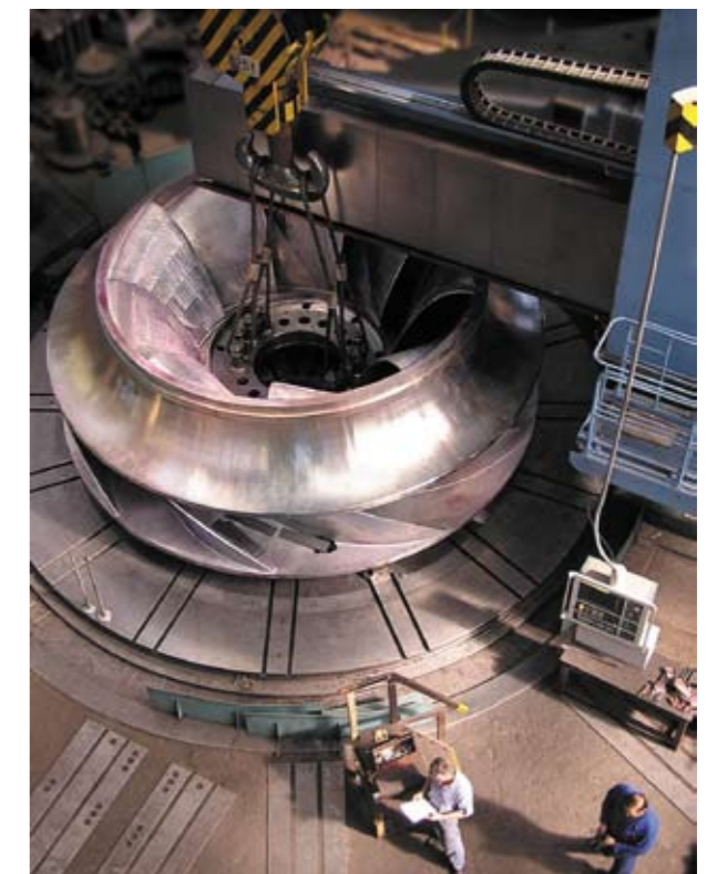
Фото 2. Производственная площадка CKD Blansko. Сборка радиально-осевой реверсивной гидротурбины
