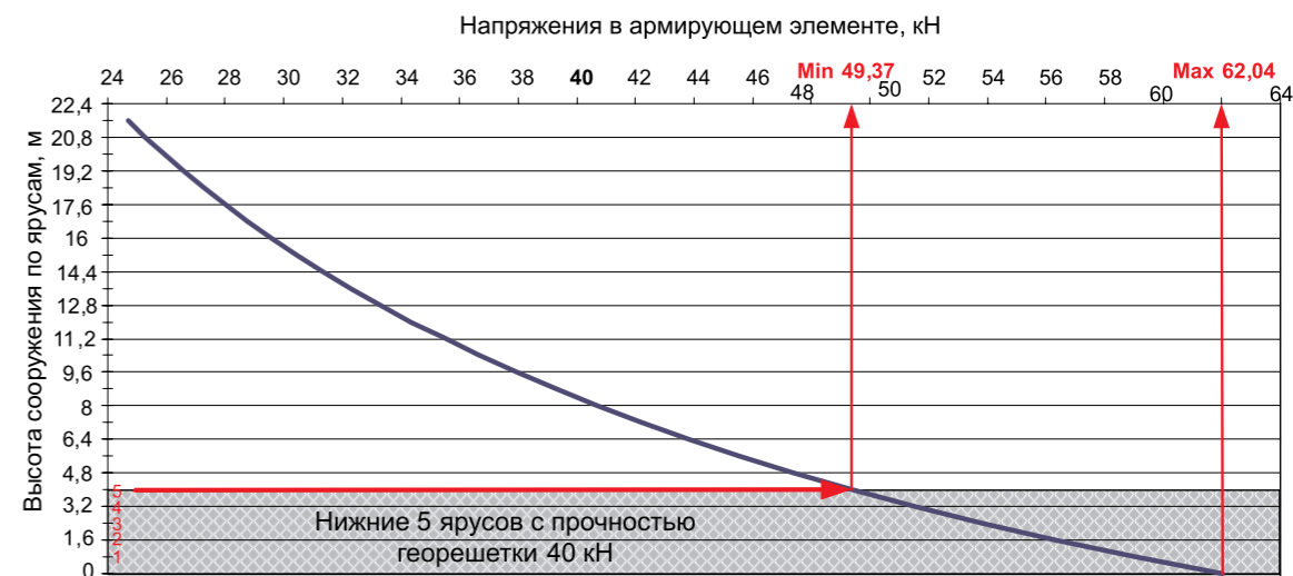
Рис. 3. График зависимости напряжений в георешетке от высоты конструкции
