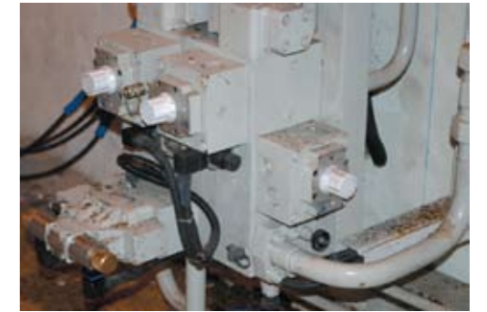
Рис. 4. Стенд с элементами гидросистемы для управления затвором
