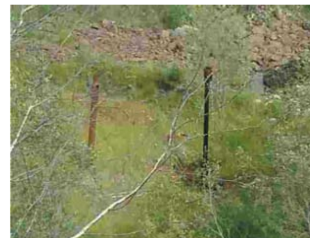
Фото 5. Старая термометрическая скважина № 57 в нижнем бьефе напротив участка работ по закачке криогеля. Фонтанировала до начала работ
