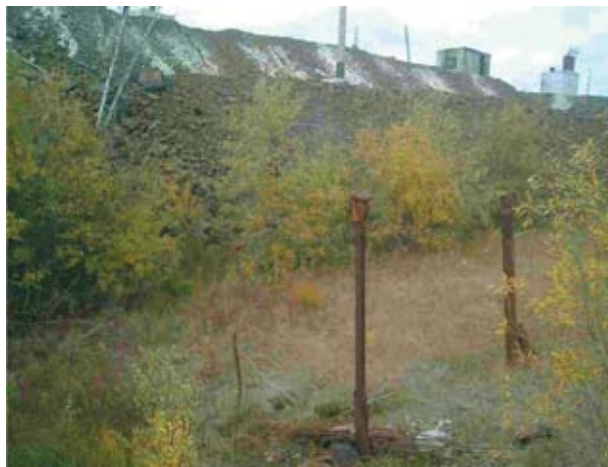
Фото 6. Старая термометрическая скважина № 57 в нижнем бьефе напротив участка работ по закачке криогеля. Перестала фонтанировать в конце работ
