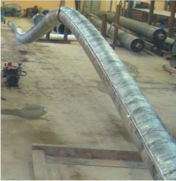
Рис. 4. Пневматический гибкий поплавок (поз. 6)
