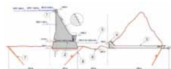
Рис. 6. Разрез по водосливной части плотины, бассейну гашения и отводящему туннелю: 1 — водослив практического профиля; 2 — временные водопропускные отверстия; 3 — строительно-эксплуатационные туннели; 4 — реконструируемый оголовок; 5 — бассейн гашения; 6 — воронка размыва; 7 — Ионахский тектонический разлом (II порядка); 8 — тектонический разлом № 35 (III порядка)
