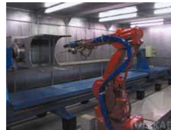
Рис. 6. Установка высокоскоростного газотермического напыления
