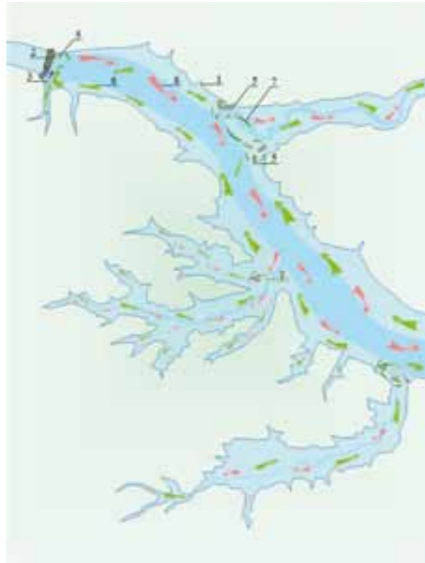
Рис. 1. Схема рыбоохранного комплекса ГЭС: 1 — водохранилище; 2 — плотина; 3 — рыбозащита на водоприемнике ГЭС; 4 — приплотинный риф; 5 — превентивный риф; 6 — траектории покатных миграций молоди; 7 — траектории кормовых миграций рыб; 8 — траектории нерестовых миграций производителей
