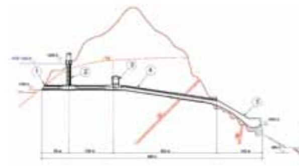
Рис. 5. Разрез по глубинному туннельному водосбросу: 1 — входной оголовок; 2 — шахта ремонтных затворов; 3 — камера основных и аварийно-ремонтных затворов; 4 — безнапорный туннель; 5 — концевое сооружение
